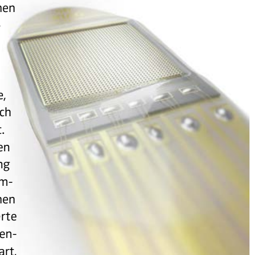
Detailansicht des subretinalen Implantats – Retina Implant Alpha AMS
