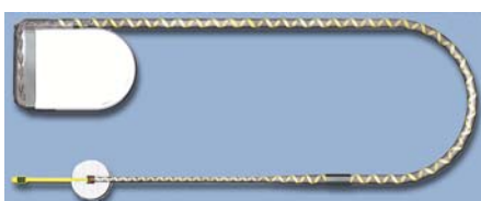
Bild 4: Implantatsystem der nächsten Generation mit implantierbarem Keramikgehäuse zur induktiven Stromversorgung
