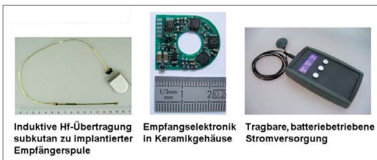
Bild 3. Die Bausteine des Retina-Implantats: Links das fertige Produkt. Dort sieht man am unteren Ende des Flachbahnleiters – kaum wahrnehmbar – den eigentlichen Chip. Das weiße Keramikgehäuse umfasst die unter die Haut implantierte Empfängerspule für die Stromversorgung. Deren Empfangselektronik zeigt das Bild in der Mitte. Ganz rechts ist die äußere Stromversorgung zu sehen. (Bild: Retina Implant AG)
